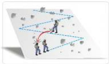
Неправильне проходження осипного схилу.
